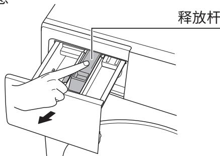
2.用水清洗所有凹槽,用小刷子清理抽屉和凹槽。
