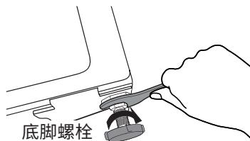
4. 检测水平底脚是否水平, 四个底脚相对地面没有晃动, 洗衣机才是水平的。您可以:
