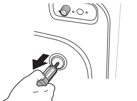
3. 用附件袋中的运输螺栓孔盖将孔塞住。
