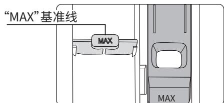
液体洗涤剂的使用量应不超过“MAX”基准线。
