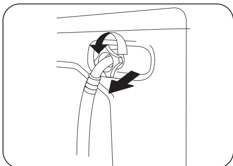
5. 将进水阀过滤盖安装回原位。
