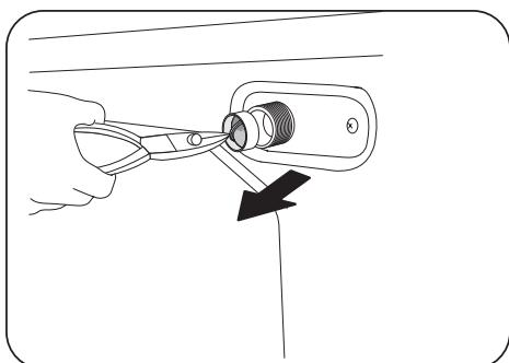
6. 重新连接进水管。打开水龙头，确保水管连接处无漏水现象。
