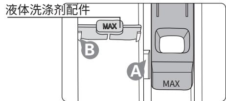
使用洗衣液时,请将液体洗涤剂配件由位置A放到位置B处。
