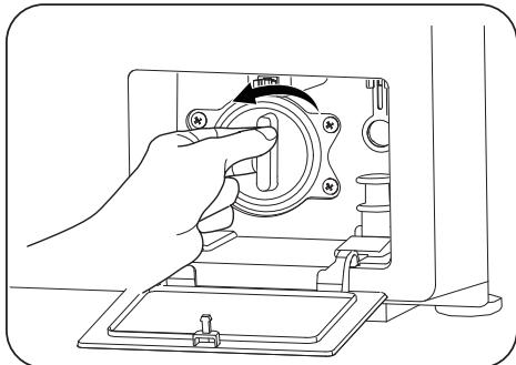
4.清洗过滤盖上的残渣和污渍,并确保排水泵内部没有被阻塞。
