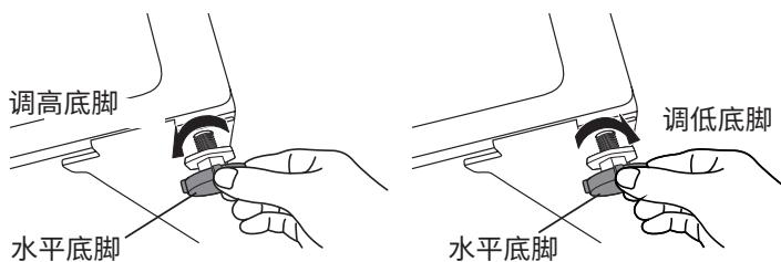
3. 用扳手将底脚螺栓旋紧。
