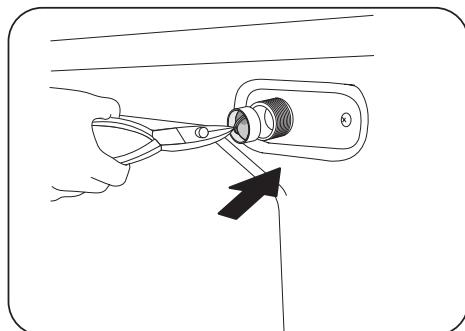
3. 使用尖嘴钳轻轻地将进水阀过滤盖从洗衣机进水阀连接口取下，用水冲洗干净。
