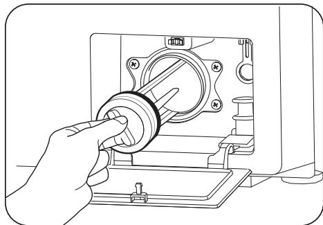
6.向右旋转装好残渣过滤盖,重新装上服务板。
