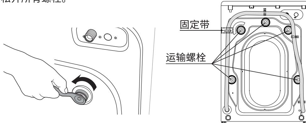
2. 抓住螺栓帽将螺栓从孔位拉出。重复相同步骤拆除所有运输螺栓。
